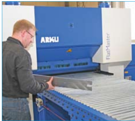
Arku FlatMaster® 50 sorgt bei der Meissle GmbH für ebene und spannungsfreie Laserteile.
