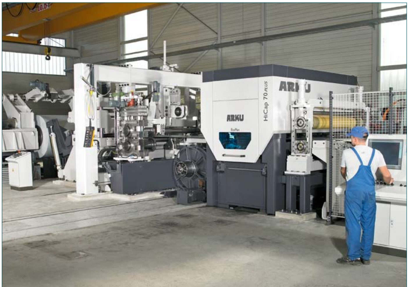
Querteilanlage mit ARKU HiCap PLUS Hochleistungsrichtmaschine in einem Stahl-Service-Center in Deutschland. (Bilder: Arku)
